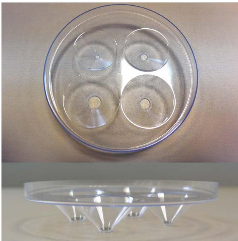
**Диск лексановый с четырьмя конусами** по своему назначению и применению аналогичен неопреновым конусам. Диск изготовлен из прочного терморезистентного пластика Лексан. В нём имеются четыре конических углубления с отверстиями при вершинах диаметром 3, 6, 8 и 10 мм. Диаметр диска 115 мм, высота бортика 8 мм, глубина конуса 17 мм.
