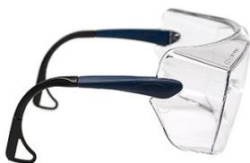
Снабжены регулируемыми заушниками с фиксацией длины в четырех положениях. Вращающиеся окончания дужек позволяют изменять способ фиксации очков. Высокочечная поликарбонатная линза защищает от летящих частиц (45 м/с), УФ-излучения и химического воздействия. Покрытие не запотеваает, устойчиво против царапин, обладает антистатическими свойствами. Оптический класс 1.
